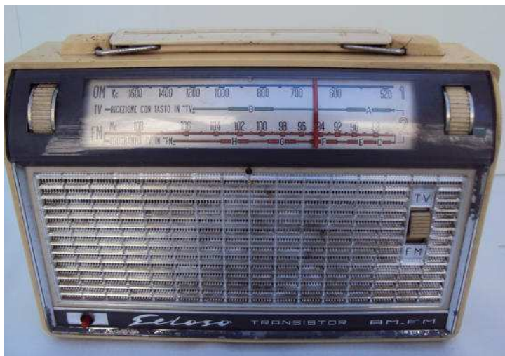
Ricevitore Geloso G 3330 adatto alla ricezione della banda prima e terza canal A-B-C- D-E-F-G-H- Ricevitore G 3330 Particolare del tasto per la ricezione TV
