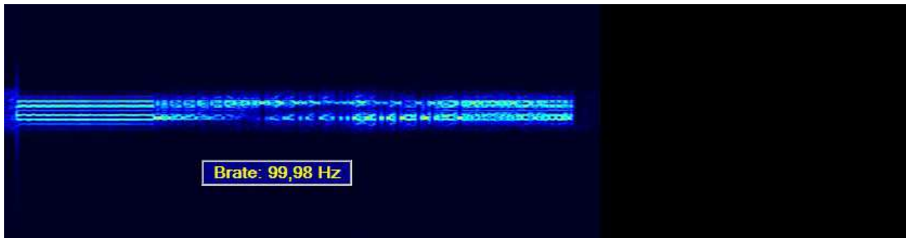
Fig. 2 – sonogramma di una trasmissione DSC e misura del baudrate
