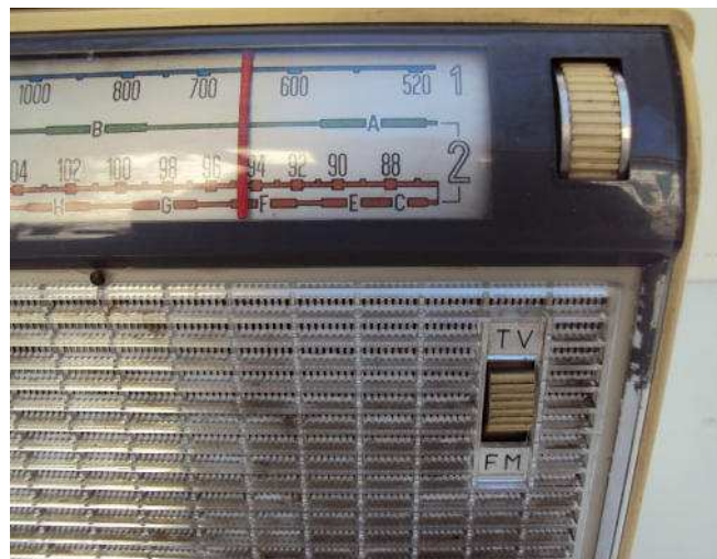
Ricevitore Geloso G 3330 adatto alla ricezione della banda prima e terza canal A-B-C- D-E-F-G-H- Ricevitore G 3330 Particolare del tasto per la ricezione TV
